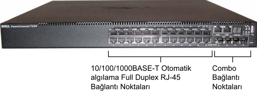
Şekil 1-1. 24 10/100/1000BASE-T Bağlantı Noktalı PowerConnect 7024
