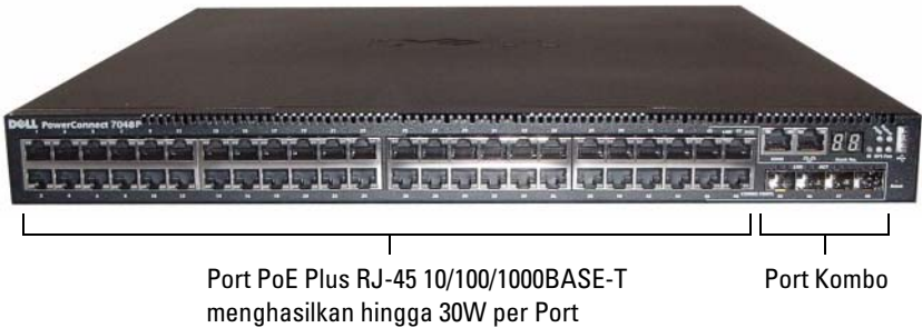
Gambar 1-5. PowerConnect 7048P dengan 48 Port PoE Plus 10/100/1000BASE-T
